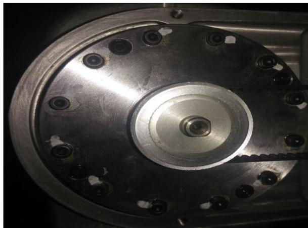
3) 对于拆卸多次的垫圈（弹簧垫圈及碟形弹簧垫圈）拆卸紧固多次后已无弹性变形力应将其废弃，固定减速机相关用垫圈（弹簧垫圈及碟形弹簧垫圈）应在拆卸 2 次后即废弃更换新的。
