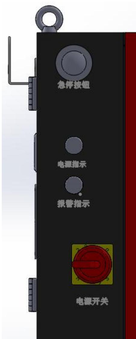
图 2-14 控制柜操作指示面板布置图
